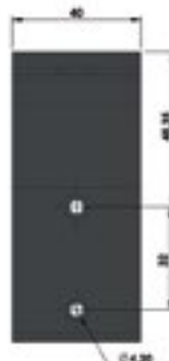
Support pour matériau plein : Béton, Brique , etc.
